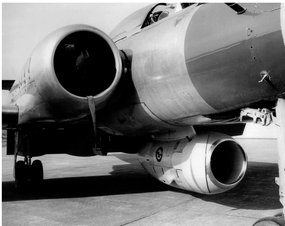
Nacelle du JT15D vue du côté droit (photo collection Doug Jermyn).
