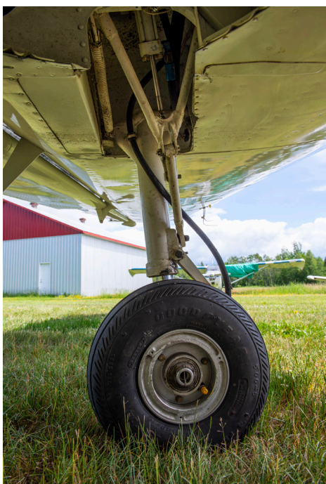
Une des particularités de l'Edelweiss est son train d'atterrissage rétractable, ce qui est assez rare pour un avion de construction amateur (photo Pierre Gillard).
