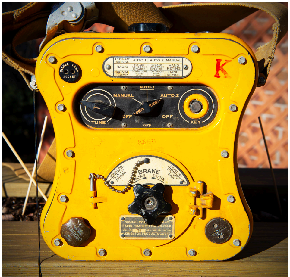
L'émetteur de secours BC-778-D aimablement prêté par notre membre Guy Lapierre. Ce type d'équipement était en usage autant dans l'aviation que dans la marine (photo Pierre Gillard).
