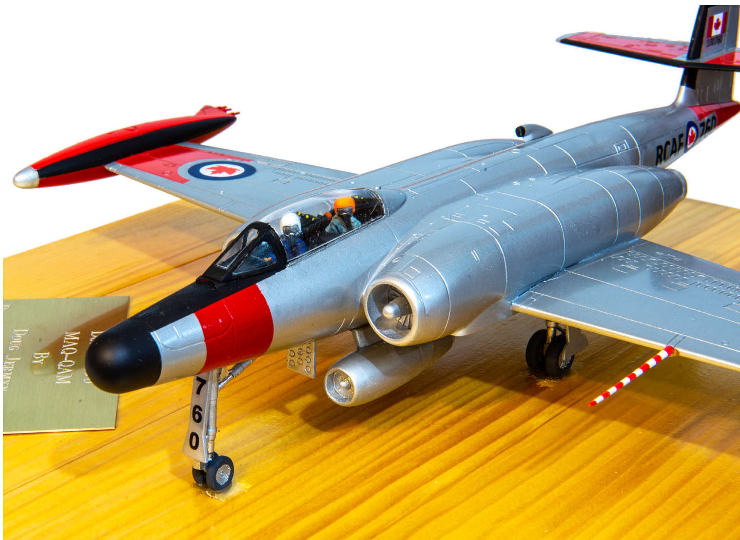
Sur la très belle maquette du CF-100 #100760 donnée par Doug Jermyn, on peut noter la nacelle du moteur Pratt & Whitney Canada JT15D montée sous le fuselage (photo Pierre Gillard).
