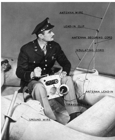
Extrait d'un manuel d'époque montrant la mise en œuvre de l'émetteur de secours « Gibson Girl » BC-778-D (archives MAQ).
