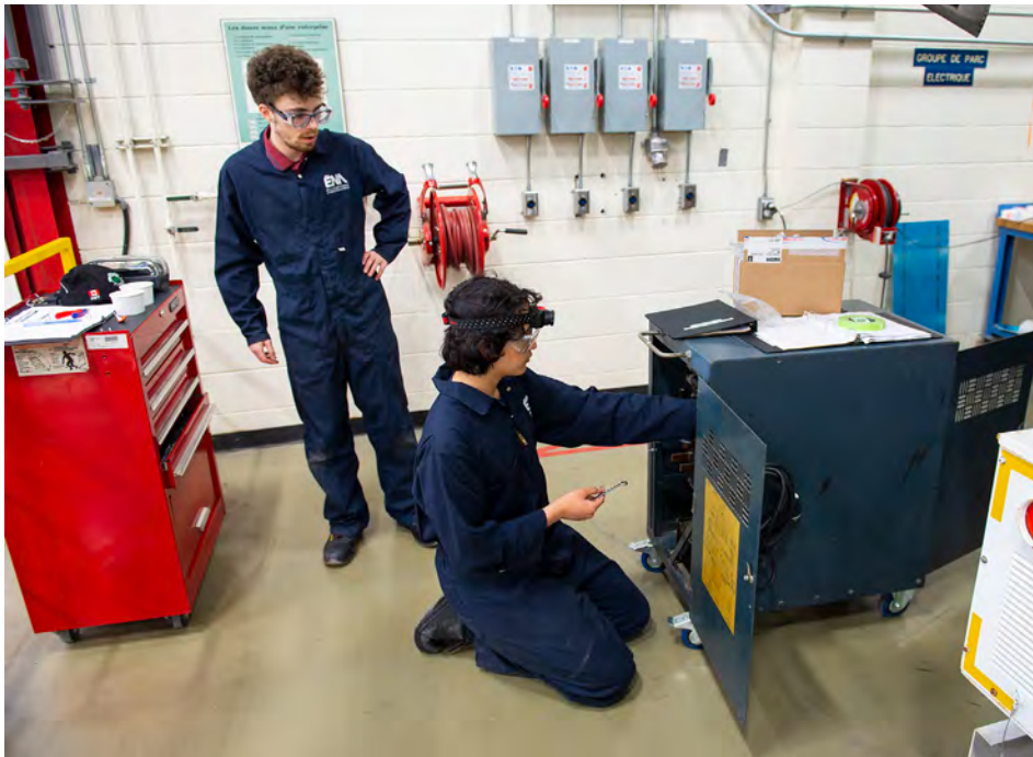
Deux étudiants du groupe « Avionique » de l'ÉNA démontant l'ampèremètre et son shunt du groupe de parc AFSG-1 (photos Pierre Gillard).
