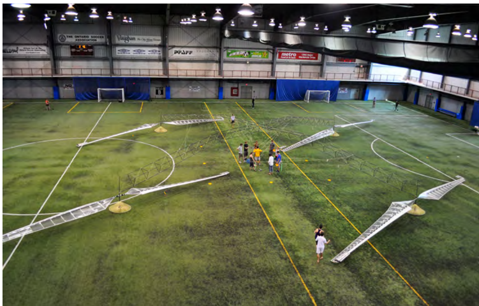
Deux vues de l'impressionnant hélicoptère à propulsion humaine (HPH) Atlas qui a permis à Todd Reichert et Cameron Robertson d'emporter le prix AHS Sikorsky en 2013. En haut, on peut distinguer un des quatre rotors équipant l'Atlas (photos AeroVelo).
