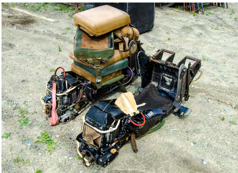
Les deux sièges éjectables Martin-Baker au moment de leur prise en charge par le MAQ à Valcourt. À l'avant-plan, on peut noter le Mk. 2 et, à sa gauche, le Mk. 2E (photo Pierre Gillard).
