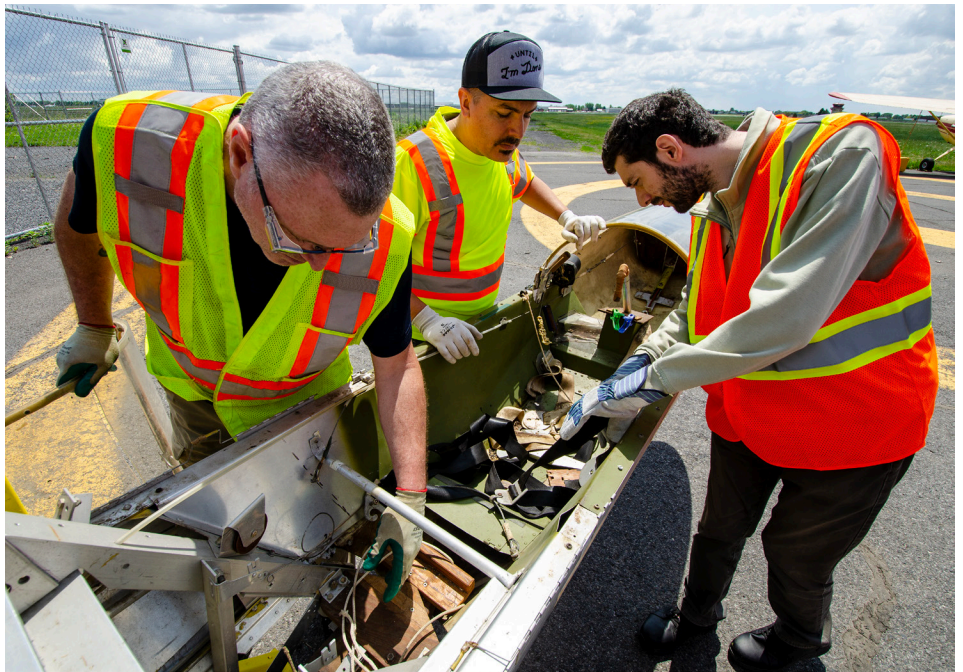
Une fois le fuselage sorti du conteneur, la verrière est démontée de même que les sangles de la ceinture de sécurité (photo Pierre Gillard).
