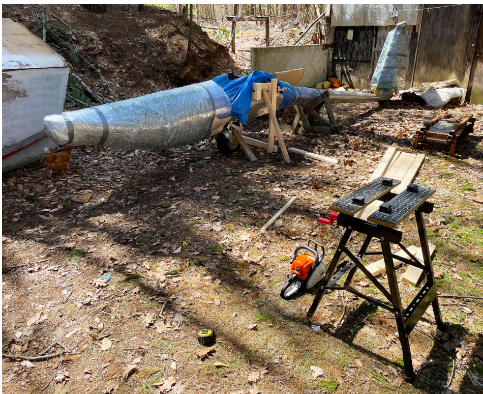
Un support réalisé en 2x4 est préparé en vue du transport du fuselage (photo Stéphane Drolet).
