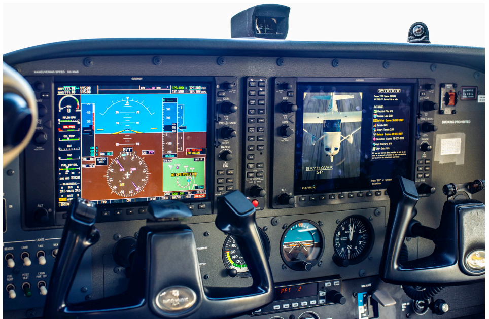
Les dernières versions du Cessna 172 SP peuvent être livrées avec un tableau de bord « Glass Cockpit » Garmin G1000. Quelle évolution depuis 1955 ! (Photo Pierre Gillard).
