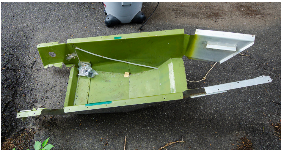
La cuvette dans laquelle le pilote prend place, dite « la baignoire », est démontée et nettoyée (photo Pierre Gillard).
