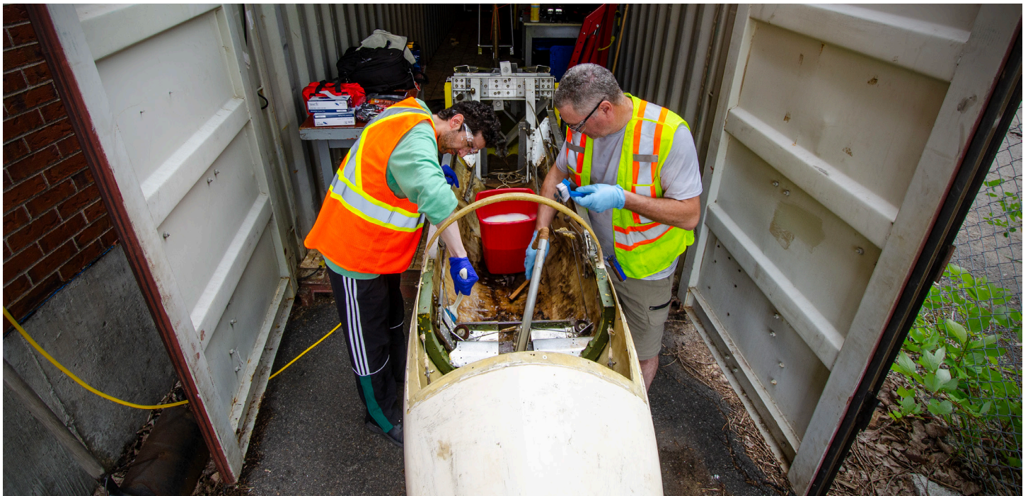
Claudiu Oltean et Stéphane Drolet nettoyant l'avant du fuselage du planeur, une tâche peu agréable, mais essentielle pour la suite du projet (photo Pierre Gillard).
