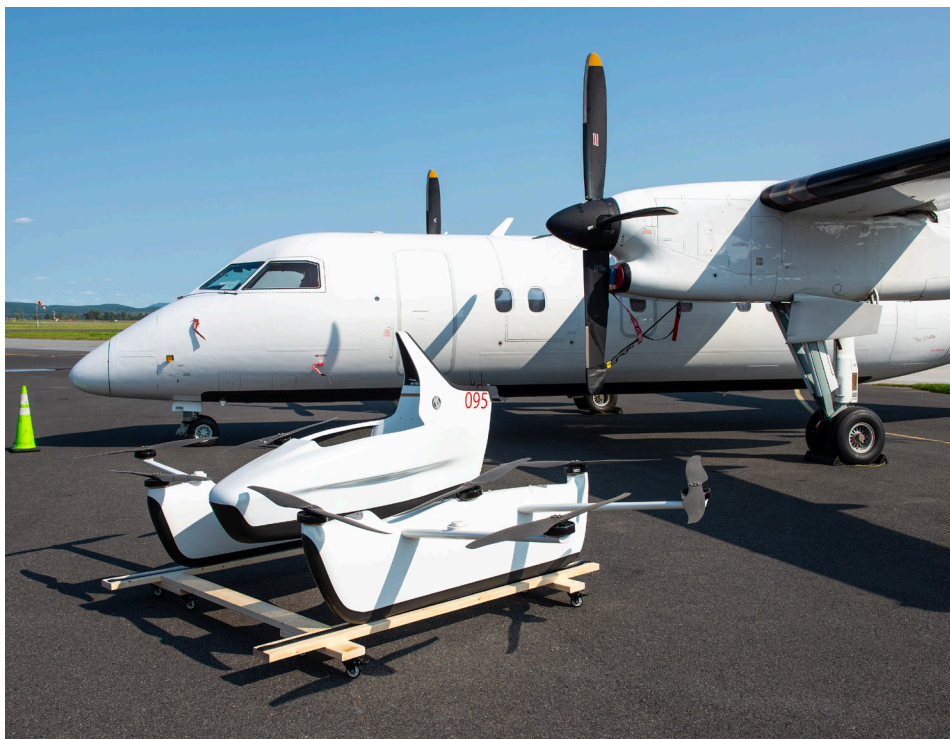
Le Flyer est photographié à côté du De Havilland Canada DHC-8-100 devant devenir le banc d'essai volant pour une motorisation hybride (photo Pierre Gillard).
