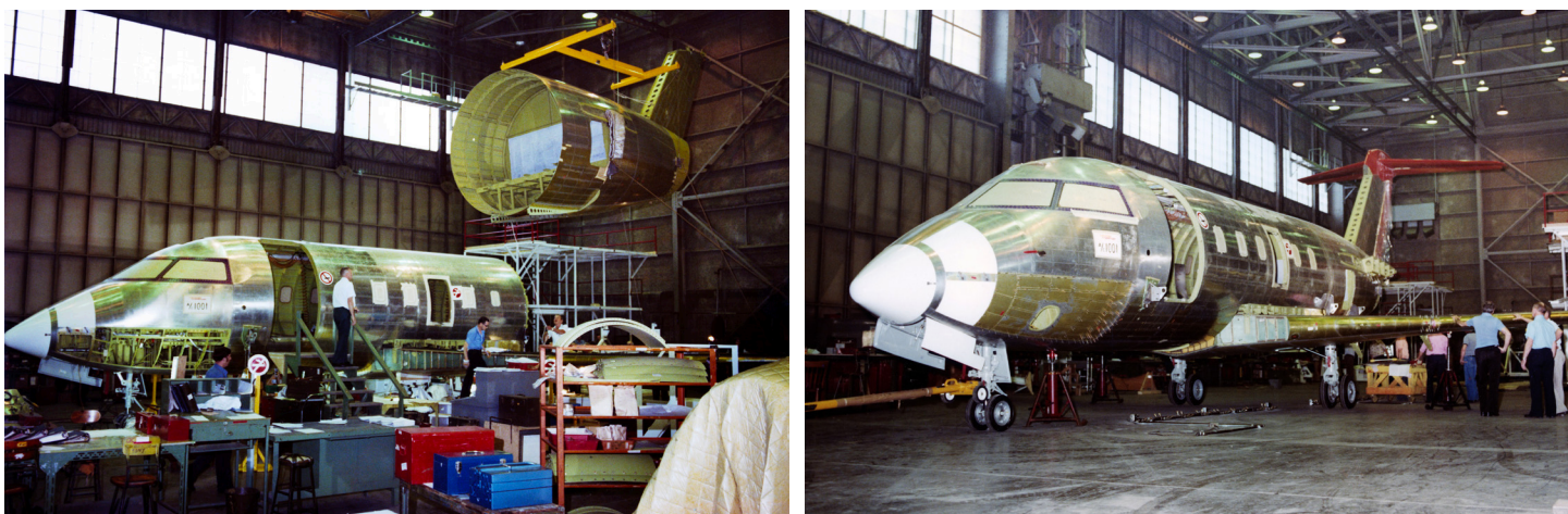
Le prototype du Canadair CL600 Challenger MSN 1001 vu lors de l'assemblage final à l'usine de Cartierville (photos Canadair, collection Larry Milberry).
