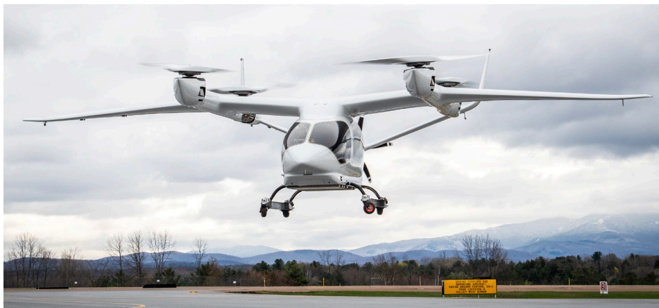
En plus de l'eCTOL « Alia », Beta Technologies expérimente également un prototype d'eVTOL (photo Beta Technologies).
